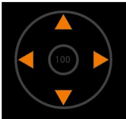
O controle Jog permite mover a máquina e alterar a velocidade de jog usando o mouse. Para mover a máquina, basta clicar dentro do círculo do controle e manter o botão do mouse pressionado. Enquanto o botão é estiver pressionado, a máquina movera na direção selecionada. Com o mouse pressionado, você podera movê-lo em qualquer direção dentro do círculo e a máquina movera na direção indicada.
