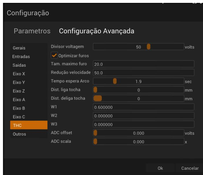
Figura 5.6. Painel de configuração THC.
